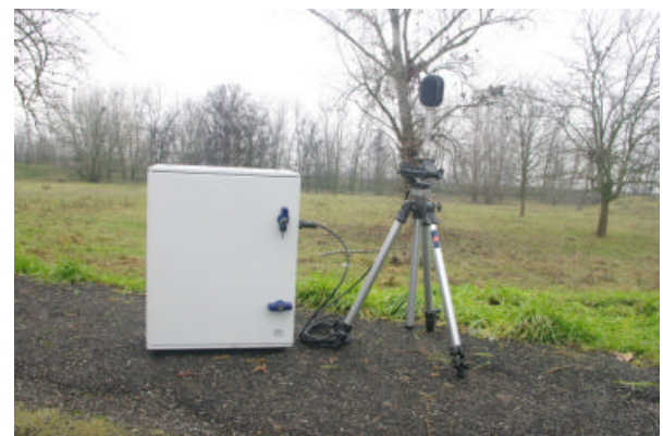
Stazione semi-permanente a batteria, chiusa
