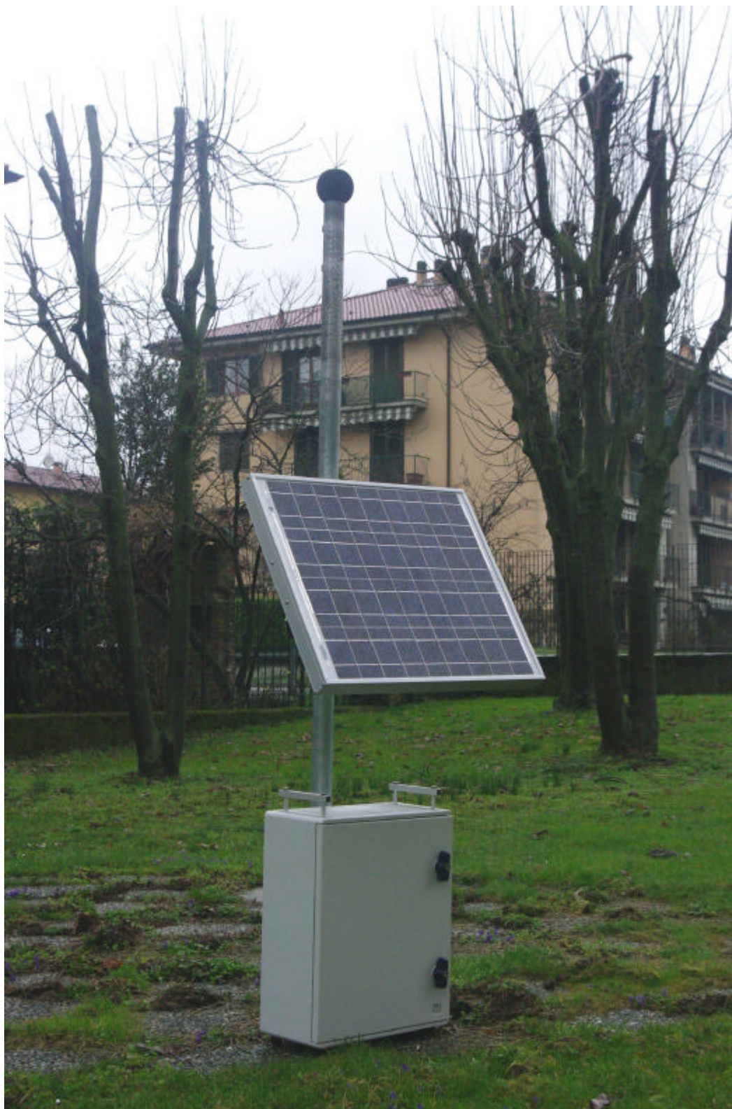
Versione alimentata a pannello solare (batt back-up per 4 giorni)
