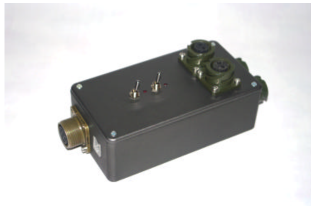
Alimentazione ed elettronica di controllo
