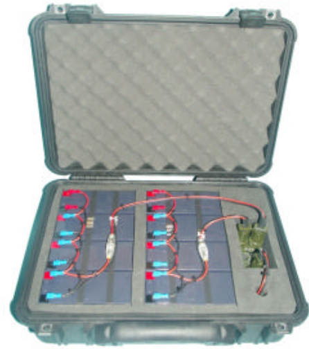
Batterie stazione rilocabile (8gg)
