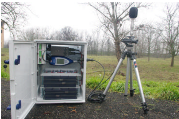
Stazione semi-permanente a batteria, aperta
